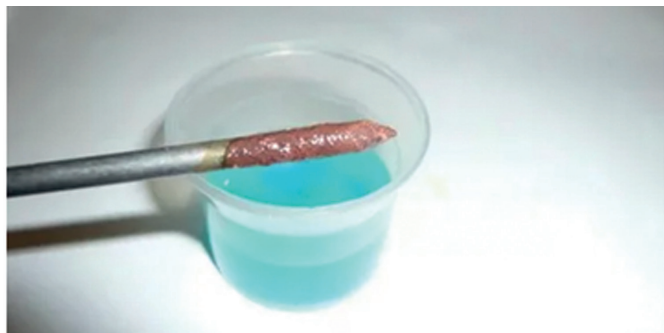
Фото 1. Результат опыта, демонстрирующего реакцию замещения
