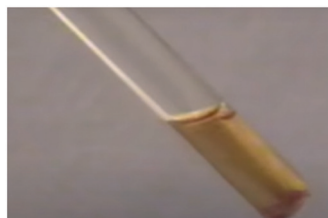
Фото 2. В пробирку с порошком меди приливают раствор хлорида железа III
