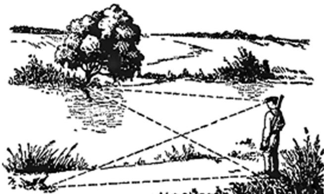
Рис. 1. Измерение ширины реки с помощью козырька
